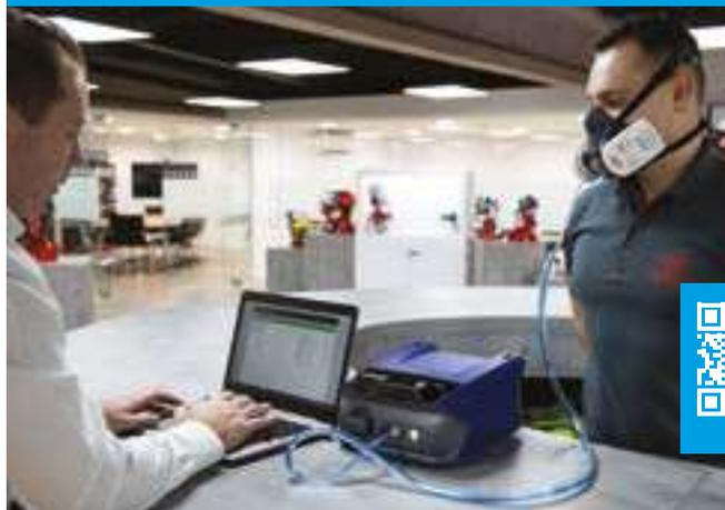
L'adaptateur de test d'ajustement quantitatif Force® Portacount/ AccuFit permet de connecter les masques Force® à l'équipement de test quantitatif TSI Portacount & AccuFit.
